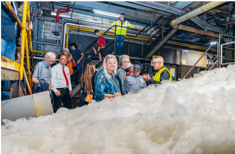
So sieht unbearbeitete Glaswolle aus, bevor sie gepresst und zu Dämmplatten verarbeitet wird.
