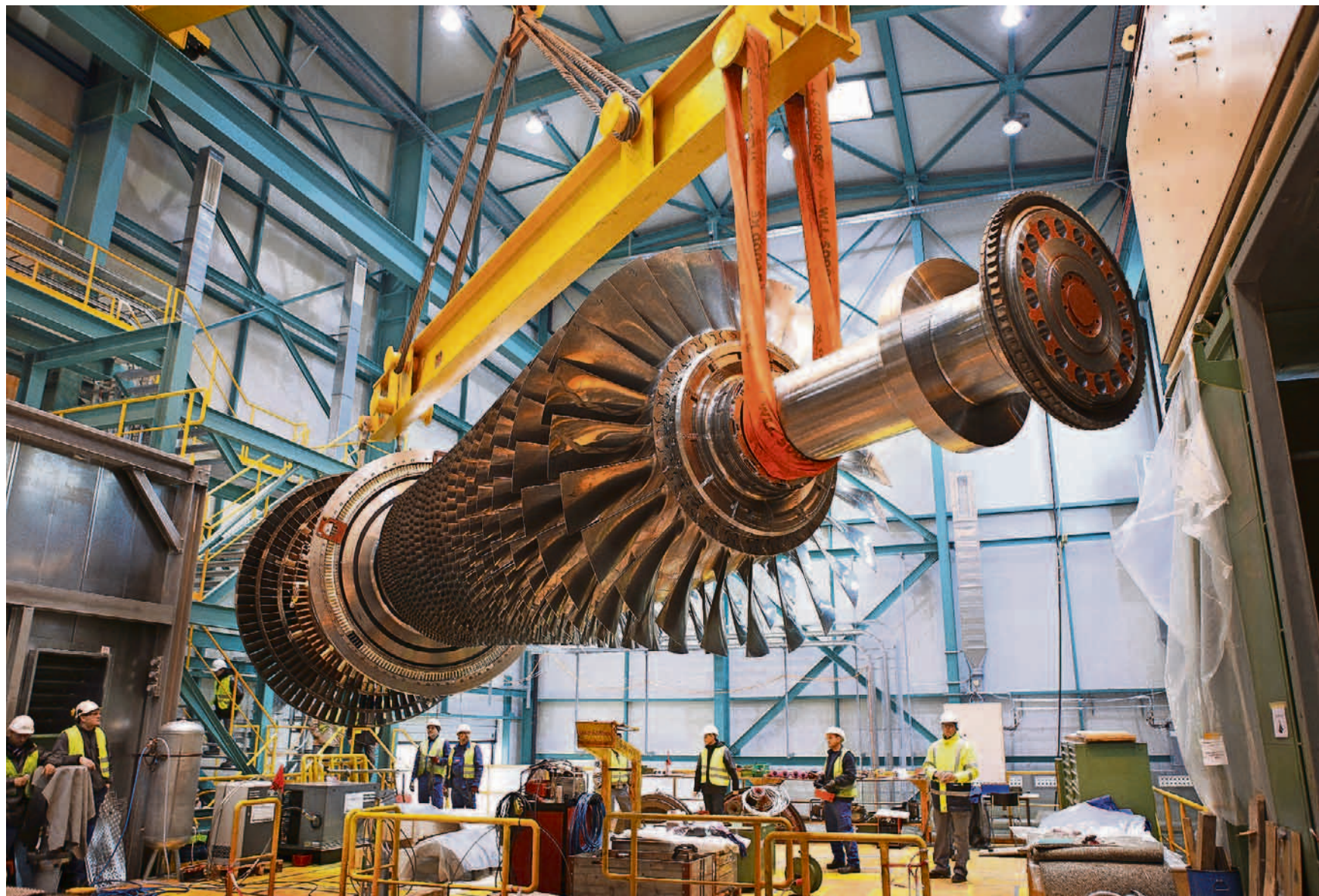
Ein moderner Gasturbinenrotor schwebt im Alstom-Werk Birm über die Köpfe der Mitarbeiter.
