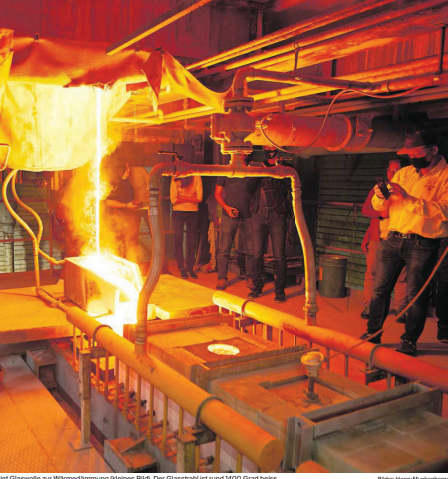
Im Durchmesser schneidet die Sager AG Glas bis zu 70 Prozent recycelt ein und fertigt Glaswolle zur Wärmedämmung (Alfons Blied). Der Glasstrahl ist rund 3000 Grad heiß.
