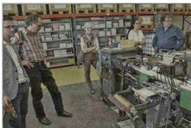
Auf dieser seit Jahren im Einsatz stehenden Maschine werden die Hüllen der Tischbomben vor dem Befüllen etikettiert.
