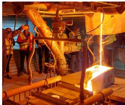
Aus geschmolzenem Glas entstehen bei der SAGER AG Dämmelemente.
