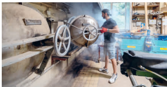
Begeisterung für Holz bei der K. Winkler AG in Felsenau: Nachdem das Holz im Dampfboiler erhitzt wurde, lässt es sich in die gewünschte Form biegen.
