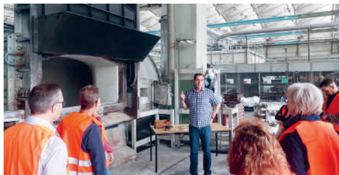
700 Grad Celsius: Im Ofen der Alu Menziken Extrusion AG wird Aluminium geschmolzen und zu Teilen, zum Beispiel für die Automobil- oder Flugzeugindustrie, verarbeitet.
