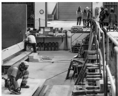
Fertigung von Betonelementen der Element AG.
